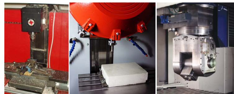
Obr. 4-8 Jednoduchá pracovní hlava 3D frézky, karuselová hlava 3D frézky a hlava 5D frézky
