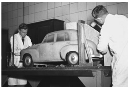
Obr. 1-50 Tvorba hliněného modelu před pár desetiletími [104]
