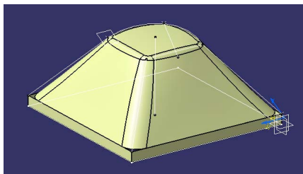
Obr. 3-104 Spojení vrchlíku s bočními stěnami R=5mm
