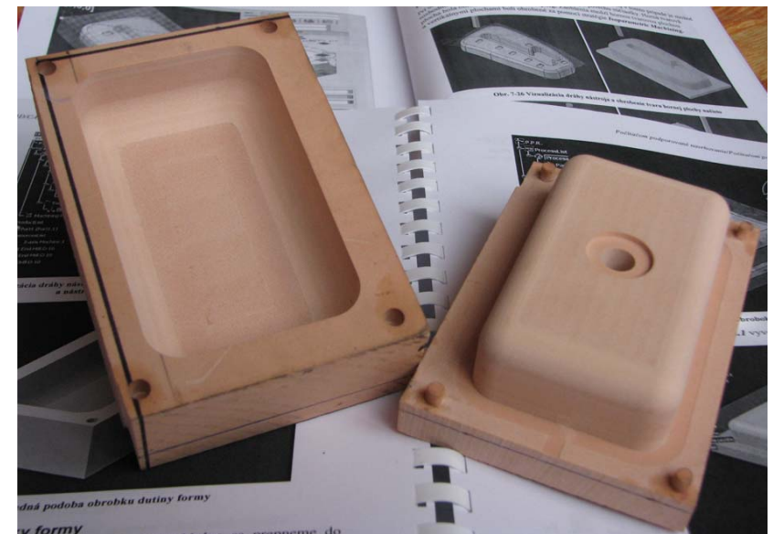
Obr. 5-126 Model formy ze syntetického dřeva
